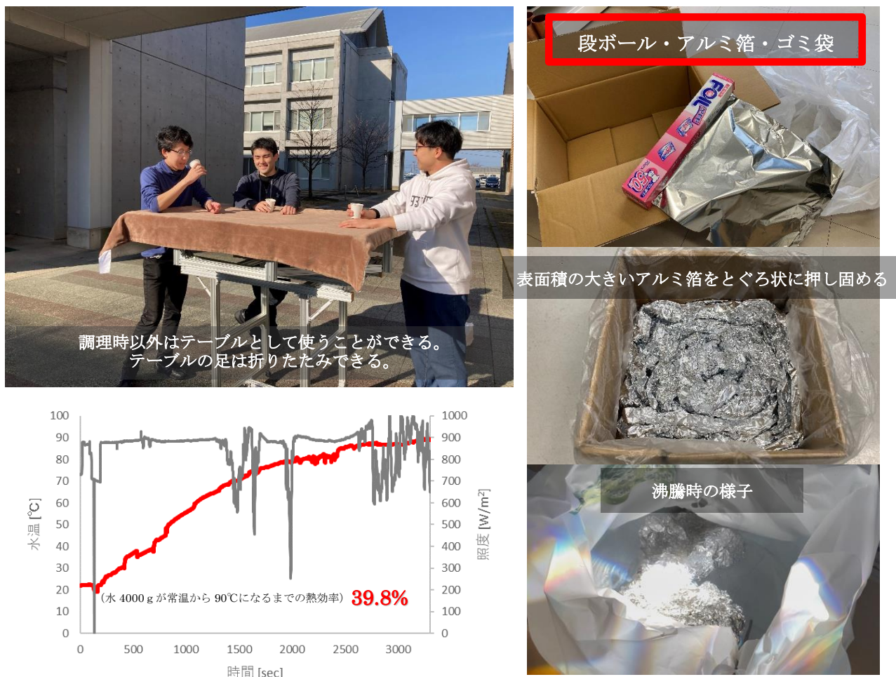
Fig. 6 汎用型フレネルレンズ式ソーラークッカー及び性能評価結果
